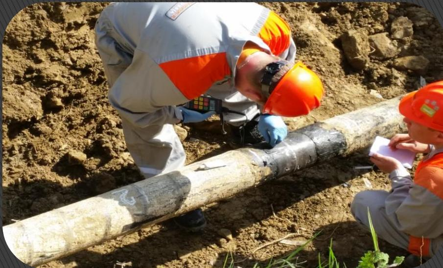
Esami, prove e rilievi condotti impiegando metodi che non alterano il materiale e non richiedono la distruzione o l'asportazione di campioni dalla struttura in esame finalizzati alla ricerca e identificazione di difetti della struttura stessa.
