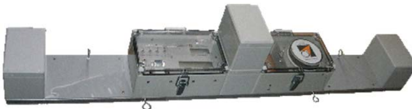
Magnetometro non a contatto
